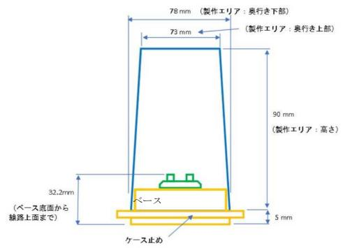
ベース下面からレール上面の高さは 32 mm~33 mmの間に制作してください。 ベース上面を 25 mmに制作すれば、レール高さが 7.2 mmですので上記に入りま す。
